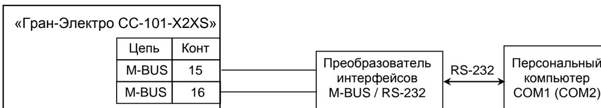
Рисунок В.6 – Схема подключения счетчиков «Гран-Электро СС-101-Х2XS» к персональному компьютеру по интерфейсу M-BUS
