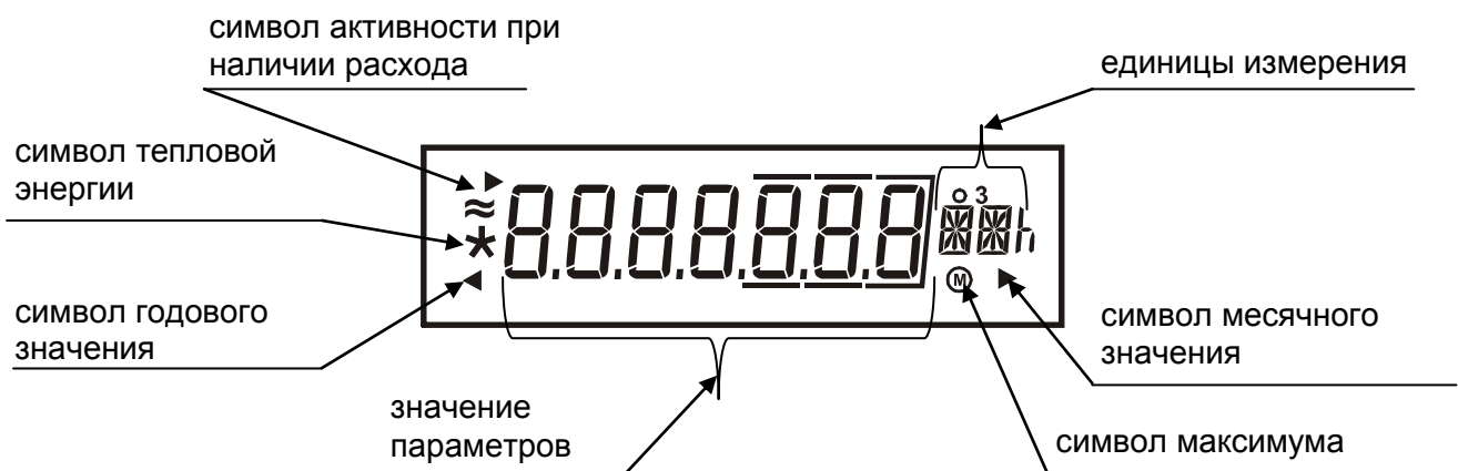
Рисунок 3.1 – Внешний вид дисплея ТС и зоны индикации параметров
