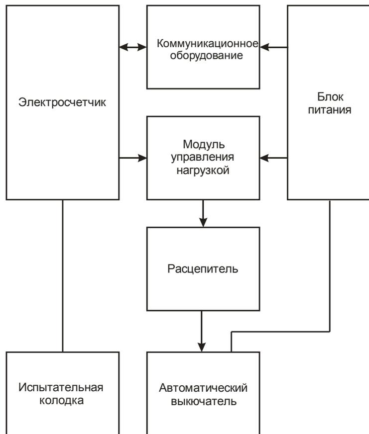
Рисунок 3 – Общая структурная схема ШУЭ со счетчиком трансформаторного включения
