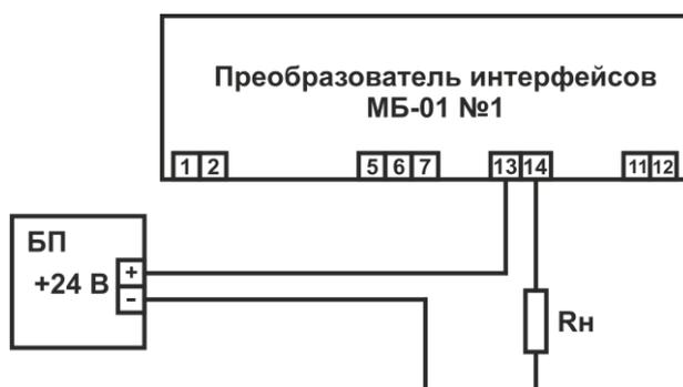
Рисунок Б.2 – Схема подключения к цепи сигнализации преобразователей МБ-01 где  $R_n$  – сопротивление нагрузки.
